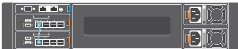
Рисунок 6. Вид сзади с двумя модулями ввода-вывода серии FN
