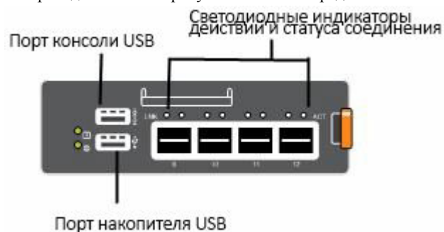
Рисунок 1. Передняя панель модуля ввода-вывода серии FN.
