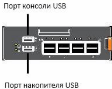
Рисунок 2. Порты USB на передней панели
